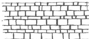
**APPAREIL RÉGLÉ** disposition des pierres taillées pour former des joints horizontaux rectilignes, mais dont les hauteurs sont variables
