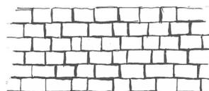
**APPAREIL RÉGULIER** disposition des pierres taillées pour former des joints horizontaux rectilignes, avec des hauteurs similaires
