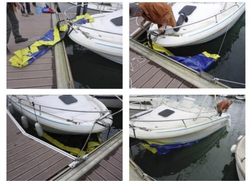
Expérimentation de la pose d'un parefouling
